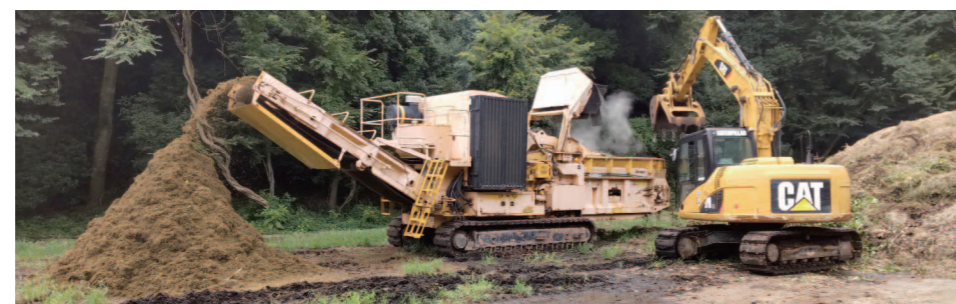
右側のショベルカーで草・わら類を掴み、左側のチップ処理機の右端の投入口に投入。処理機の左側から粉砕片を連続して排出。
