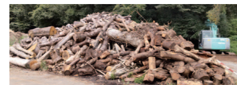
木の幹は、ショベルカーの先端で握りつぶして小さな木片にしてから、チップ化処理。
